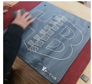
Schleifvorgang, nachdem die Fräsbahnen mit weißer Feinspachtel gefüllt wurden
